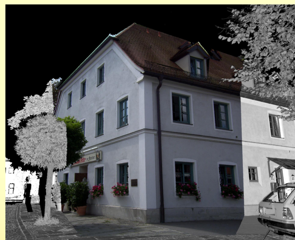
Kombination aus Kameraaufnahmen und kinematischen Laserscanner-Messdaten
